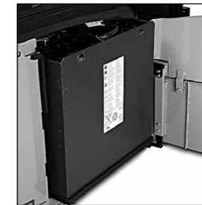
Sostituzione laterale della batteria.
